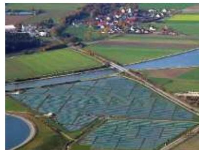
FIGURE 6.7. Une ferme solaire photovoltaïque : le Solarpark de 6,3 MW (en crête) à Mühlhausen, en Bavière. On s'attend à ce que sa puissance moyenne par unité de surface soit d'environ 5 W/m<sup>2</sup>. Photographie fournie par SunPower.
