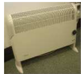
FIGURE 7.6. Un gros radiateur électrique : 2 kW.
