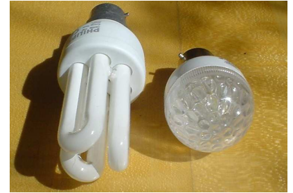
FIGURE 9.4. Ampoule Philips de 11 W à côté d'une ampoule à LED de 1,3 W.
