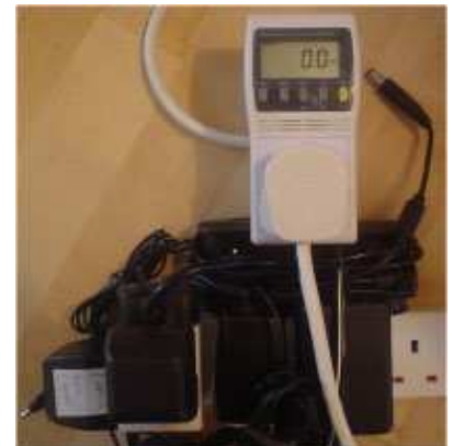
FIGURE 11.2. Ces cinq chargeurs — trois pour les téléphones portables, un pour un ordinateur de poche, et un pour un ordinateur portable — se révèlent consommer moins d'un watt, indique mon wattmètre.
