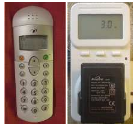
FIGURE 11.3. Ce téléphone sans fil si gourmand et son chargeur consomment 3 W lorsqu'on les laisse branchés. Cela fait 0,07 kWh/j. Si l'électricité coûte 11 centimes d'euro par kWh, alors cette petite fuite de 3 W va coûter 3 euros chaque année.
