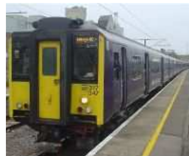
FIGURE 20.4. Ce train à 8 voitures, lancé à sa vitesse maximum de 160 km/h, consomme 1,6 kWh pour 100 passager-km , lorsqu'il est plein.
