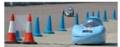
FIGURE 20.2. L'éco-voiture Team Crocodile consomme 1,3 kWh pour 100 km. Photo gracieusement fournie par Team Crocodile. www.teamcrocodile.com
