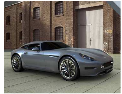
FIGURE 20.39. Lightning : 11 kWh pour 100 km. Photo de www.lightningcarcompany.co.uk .
