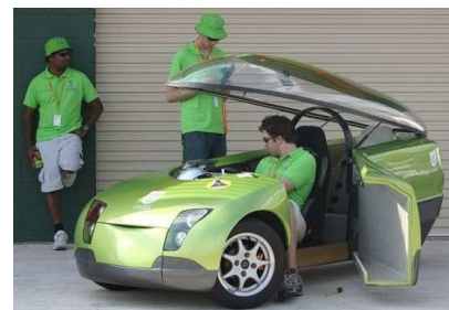
FIGURE 20.42. Le TREV. 6 kWh pour 100 km . Photo de www.unisa.edu.au .
