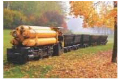
FIGURE 20.24. En haut : un tramway à air comprimé embarquant de l'air et de la vapeur à Nantes. Alimenter les tramways de Nantes consommait 4,4 kg de charbon (36 kWh) par véhicule-km, soit 115 kWh pour 100 p-km si les tramways étaient pleins. [5qhvcb] En bas : Une locomotive à air comprimé ; poids : 9,2 tonnes ; pression : 175 bars ; puissance : 26 kW. Photos gracieusement fournies par Rüdiger Fach, Rolf-Dieter Reichert et le Frankfurter Feldbahnmuseum.
