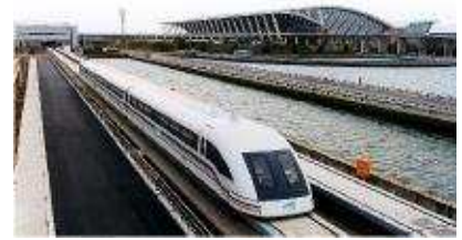
FIGURE 20.33. Un train Maglev à sustentation magnétique à l'aéroport international de Pudong, à Shanghai. « Rouler sans roue, voler sans aile. » Photo d'Alex Needham.
