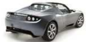
FIGURE 20.22. La Tesla Roadster : 15 kWh pour 100 km . www.teslamotors.com .
