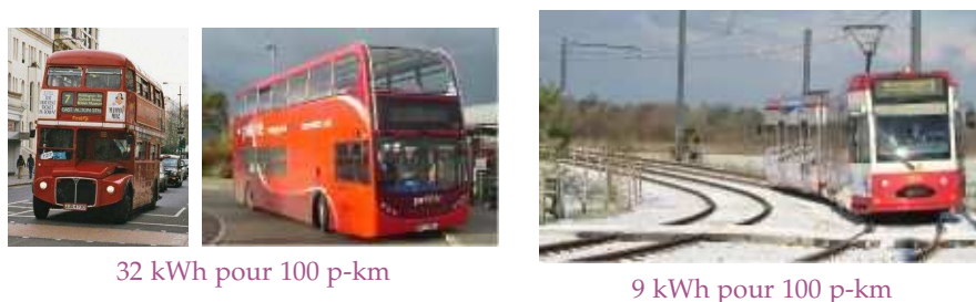
FIGURE 20.7. Quelques transports publics, et leur consommation moyenne d'énergie. A gauche : Quelques célèbres bus rouges britanniques. A droite : Le tramway de Croydon. Photos de Stephen Parascandolo.
