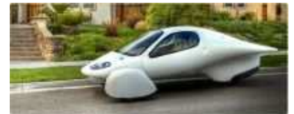
FIGURE 20.40. L'Aptera. 6 kWh pour 100 km. Photo de www.aptera.com .
