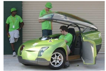
FIGURE 20.42. Le TREV. 6 kWh pour 100 km . Photo de www.unisa.edu.au .
