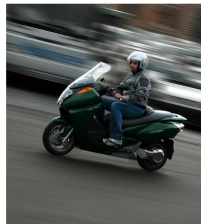
FIGURE 20.44. Vectrix : 2,75 kWh pour 100 km . Photo de www.vectrix.com .
