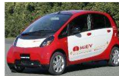
FIGURE 20.38. La i MiEV de Mitsubishi Motors Corporation. Elle a un moteur de 47 kW, pèse 1 080 kg, et une vitesse de pointe de 130 km/h.
