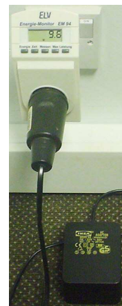
FIGURE 22.1. Un affreux transformateur-prise pour lampe de chez IKEA — il consomme près de 10 W même quand la lampe est éteinte !
