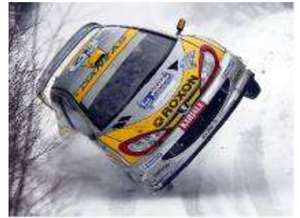
FIGURE A.1. Une Peugeot 206 a un coefficient de traînée ( C_x ) de 0,33 (coefficient appelé aussi, à tort, coefficient de pénétration dans l'air). Photo de Christopher Batt.
