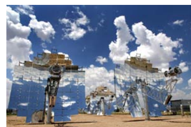
Figure 5. Paraboles de Stirling. Ces superbes concentrateurs fournissent une puissance par unité de surface de 14 W/m 2 . Image gracieusement fournie par Stirling Energy Systems. www.stirlingenergy.com
